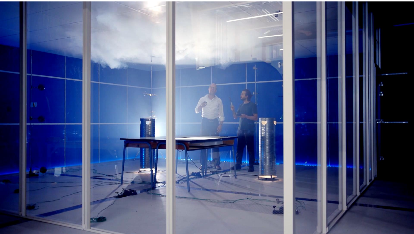
Rauchversuch im Raumluft- und Klimatechniklabor
